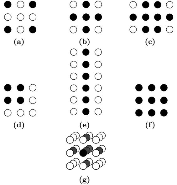
**Figure 10:** Memory access patterns of benchmarks — (a) BICUBIC, (b) DECONV, (c) DENOISE-UR, (d) MOTION\_C, (e) MOTION\_LV, (f) SOBEL, (g) STENCIL3D.
